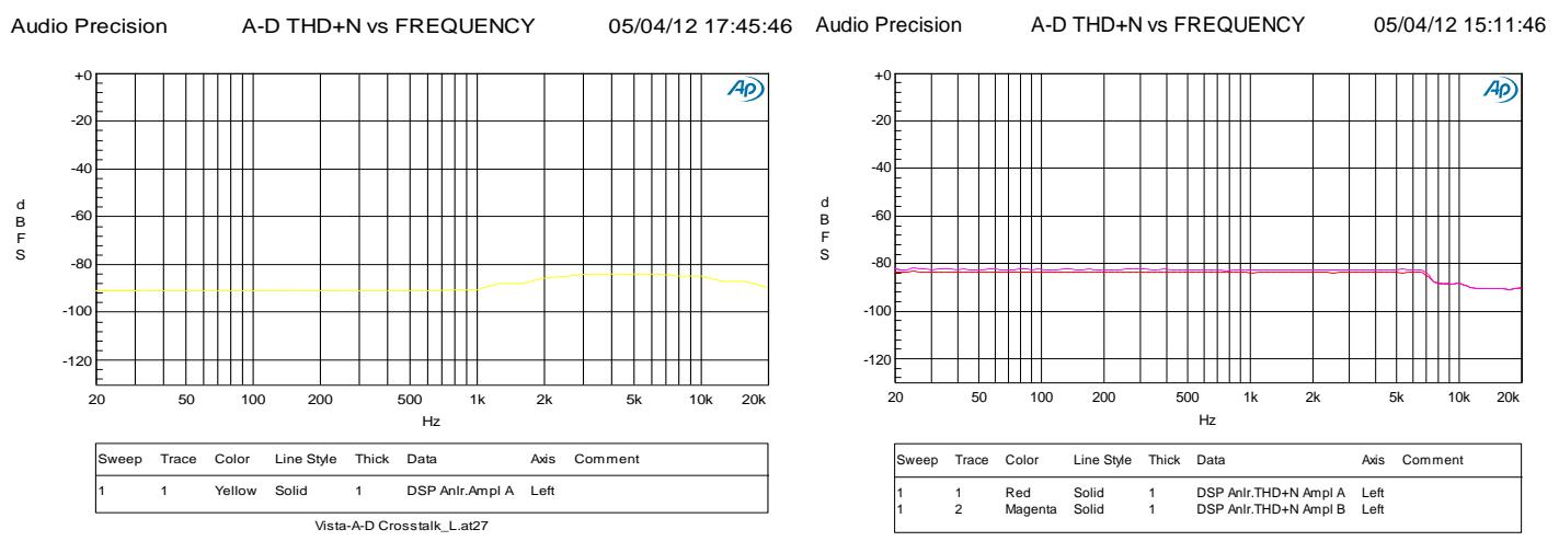
FIGURE 27. 96K/24BIT, MICROPHONE IN, CHANNEL SEPARATION L
