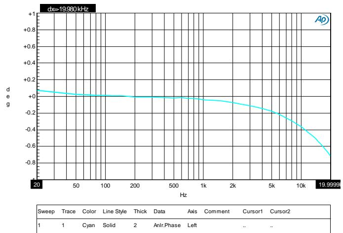
FIGURE 12. 96K/24BIT, 10K LOADING DAC, PHASE DELAY
