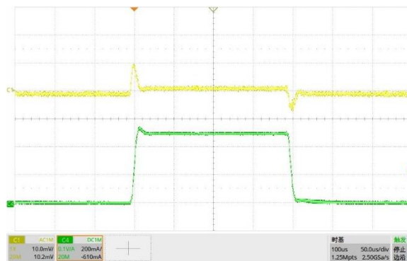
图 16. 负载瞬态响应, V_{IN} = -6V , V_{OUT} = -5V , I_O = -10 至 -500mA
