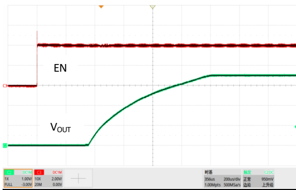
图 21. 软启动, V_{IN}=4.3V , V_{OUT}=3.6V , I_{OUT}=200mA
