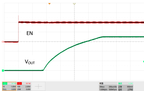
图 21. 软启动, V_{IN}=4.3V , V_{OUT}=3.6V , I_{OUT}=200mA
