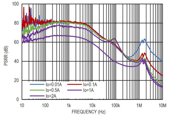
图 17. 电源电压纹波抑制比,  $V_{IN}=5V$ ,  $V_{OUT}=3.3V$
