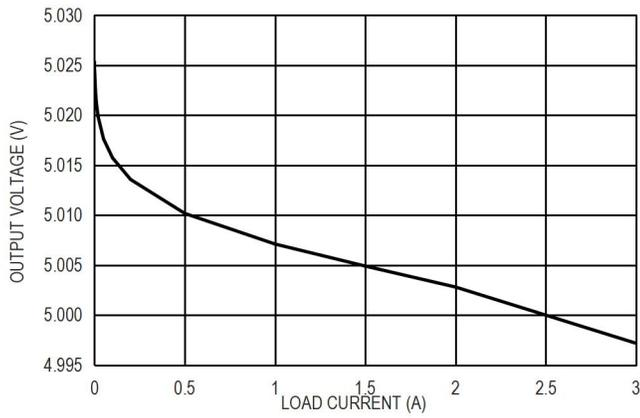
图 10. 5.0V 输出电压和负载电流的关系
