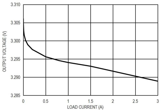
图 9. 3.3V 输出电压和负载电流的关系
