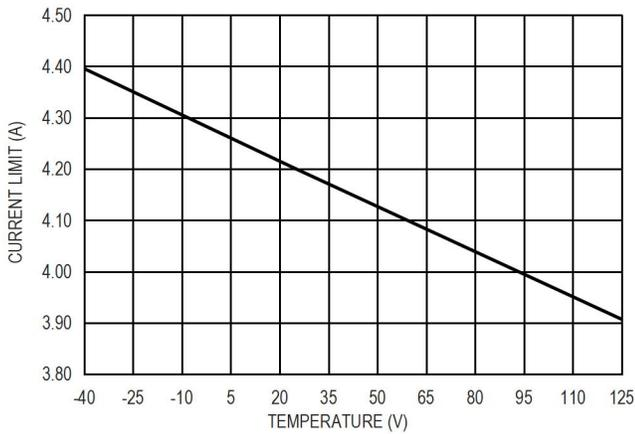
图 12. 输出限流值和温度的关系
